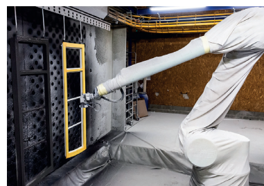
Etape 5 : Les menuiseries sont raccrochées et passent dans une deuxième cabine pour application de la finition. Avec ses 5 pompes, le robot permet de changer aisément de couleur.
