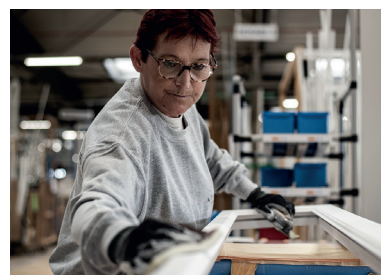
Etape 4 : Les menuiseries arrivent devant le poste égrainage. Elles sont alors décrochées et égrainées c'est-à-dire poncées légèrement. L'égrainage permet d'obtenir un état de surface parfait pour améliorer le rendu esthétique avant application.
