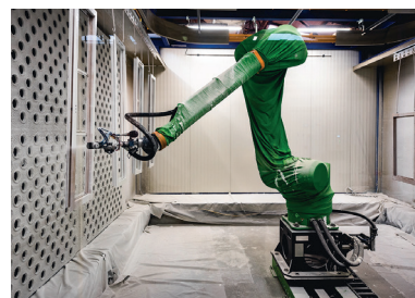
Etape 3 : Elles passent ensuite dans la cabine d'un premier robot qui applique le fond dur.
